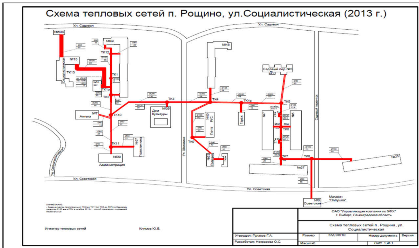
Рисунок 5 – Схема тепловых сетей производственной котельной №2 (котельная ул. Социалистическая, д.7а)
