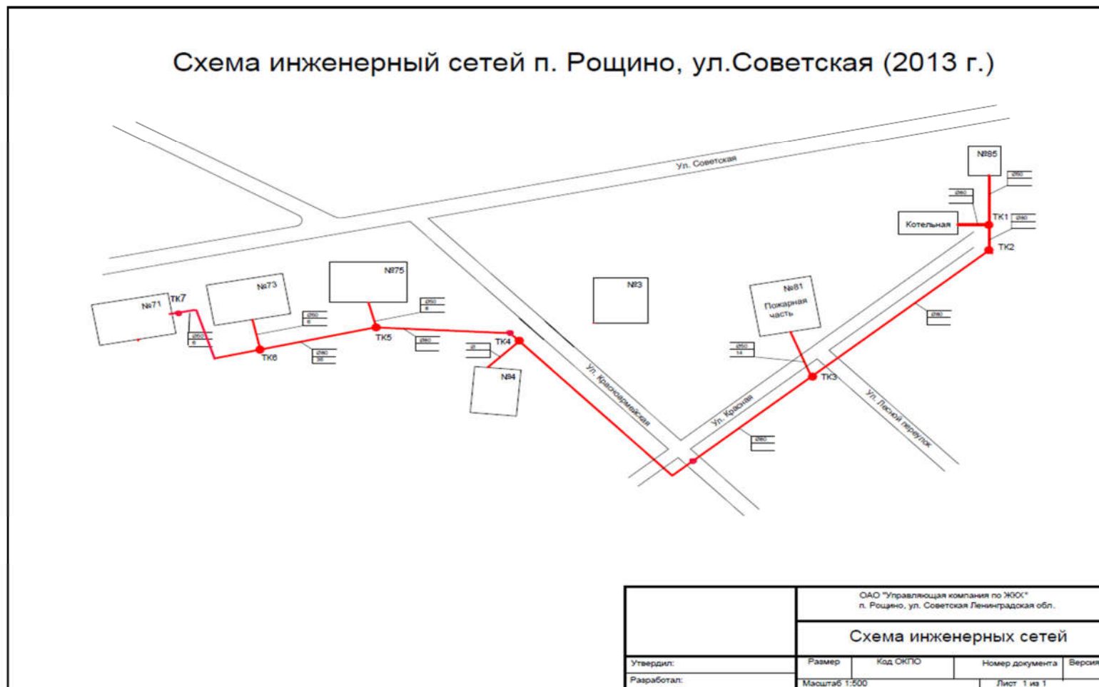
Рисунок 4 – Схема тепловых сетей технологической зоны №1 пгт. Роцино (котельная ул. Советская, д.83а)
