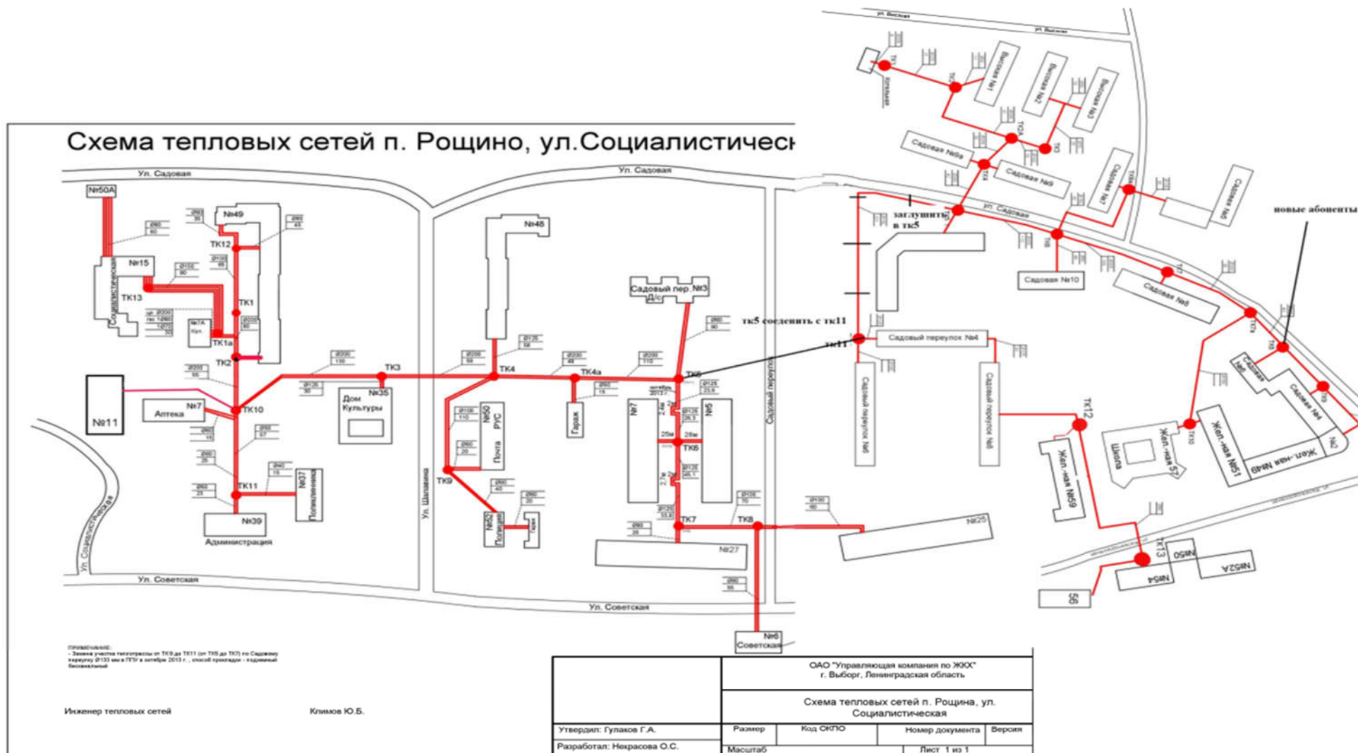
Рисунок 58 – Схема переключения потребителей от котельной ул. Высокая, д.8а, на котельную ул. Социалистическая д.7а
